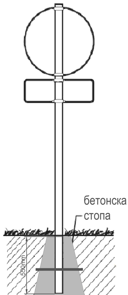
Детаљ уградње стуба носача укопавањем Р1:20
